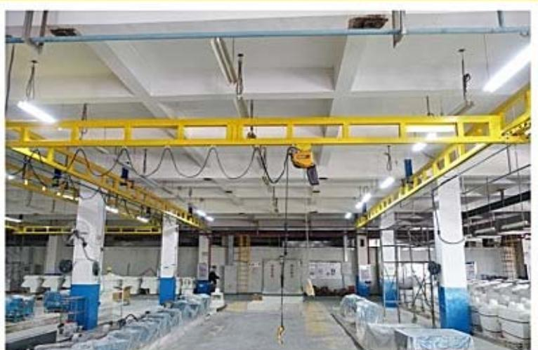
我们可以通过电动小车来驱动轻载起重机，电动小车采用高质量摩擦轮以确保移动的精度和较长的使用寿命。有三种电动方式：仅有在横梁上运动的滑行小车电动运行（M1）、仅有横梁本身电动运行（M2+M3）以及所有部件都是电动（M1+M2+M3），我们的动力驱动小车采用变频调速。
