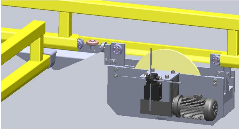
5.7 将缓冲器安装到固定型轨的动力输送端（防止主梁脱离固定型轨）。
