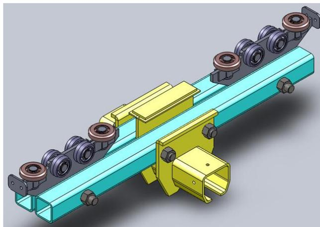
**注意** ◆ 型轨小车的套管与主梁上第一个垂直结构件的间距为 60mm。
