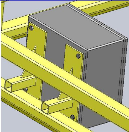
★ 提示：如果客户提出要使用 C 型轨滑线系统请按下面方式安装。
